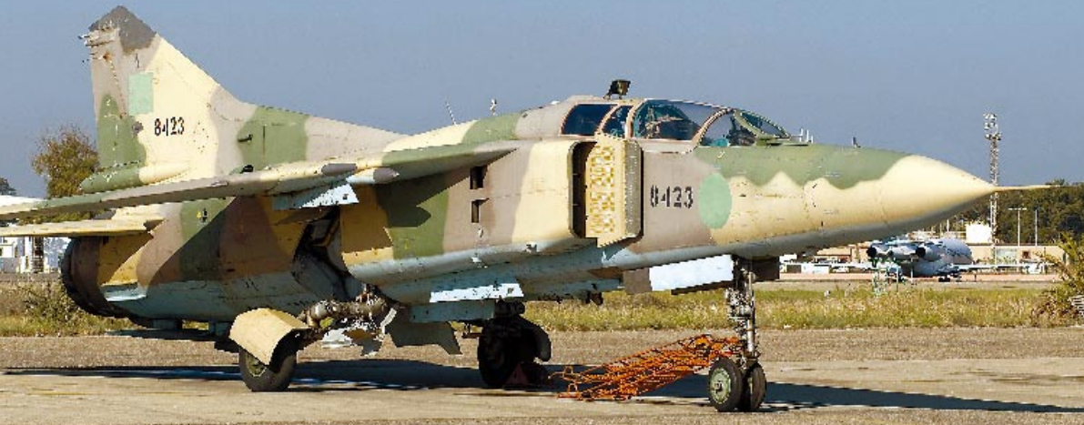
Nella pagina accanto, sopra: un MiG-23UB ("Flogger-C"), versione biposto da addestramento operativo del MiG-23; al centro: per la fase intermedia dell'addestramento sono in servizio gli Aero L-39Z0 "Albatros" di produzione cecoslovacca, dotati anche di limitate capacità di appoggio tattico; sotto: un quadrigetto Ilyushin Il-76T/TD ("Candid") da trasporto strategico. Qui sotto: un elicottero da attacco Mil Mi-35 ("Hind-E"), versione aggiornata per l'esportazione del Mi-24/Mi-25. In fondo alla pagina: alcuni SIAI-Marchetti SF-260WL "Warrior"; si tratta di esemplari recentemente sottoposti a revisione da parte di Alenia Aermacchi ed impiegati principalmente per addestramento basico.
