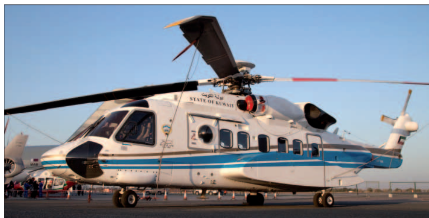
Vrtulníky S-92A používá letectvo k přepravě vládních činitelů i pátrací a záchranné službě
