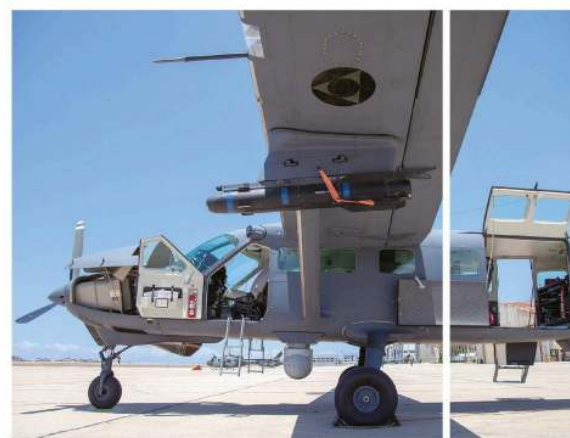
▲ AC-208은 2발의 헬파이어 미사일로 무장할 수 있으며, 첨단장비를 이용해 ISR 임무를 수행한다. 이 외에도 화물 및 병력 이송용으로 운용되는 경우도 있다.
