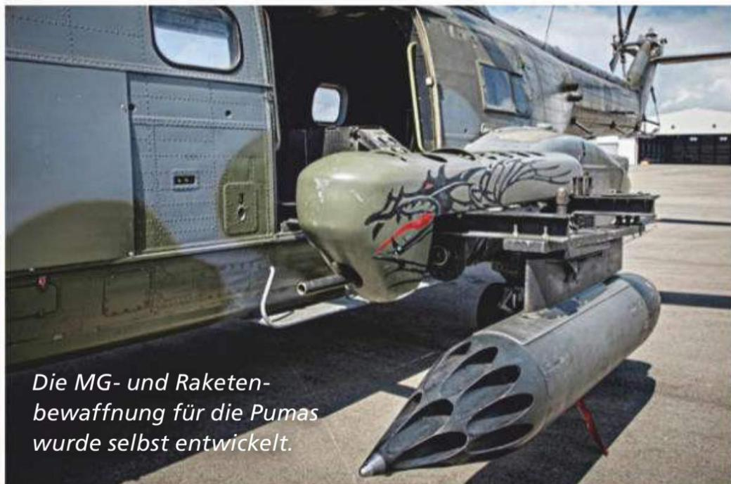
Die MG- und Raketenbewaffnung für die Pumas wurde selbst entwickelt.
