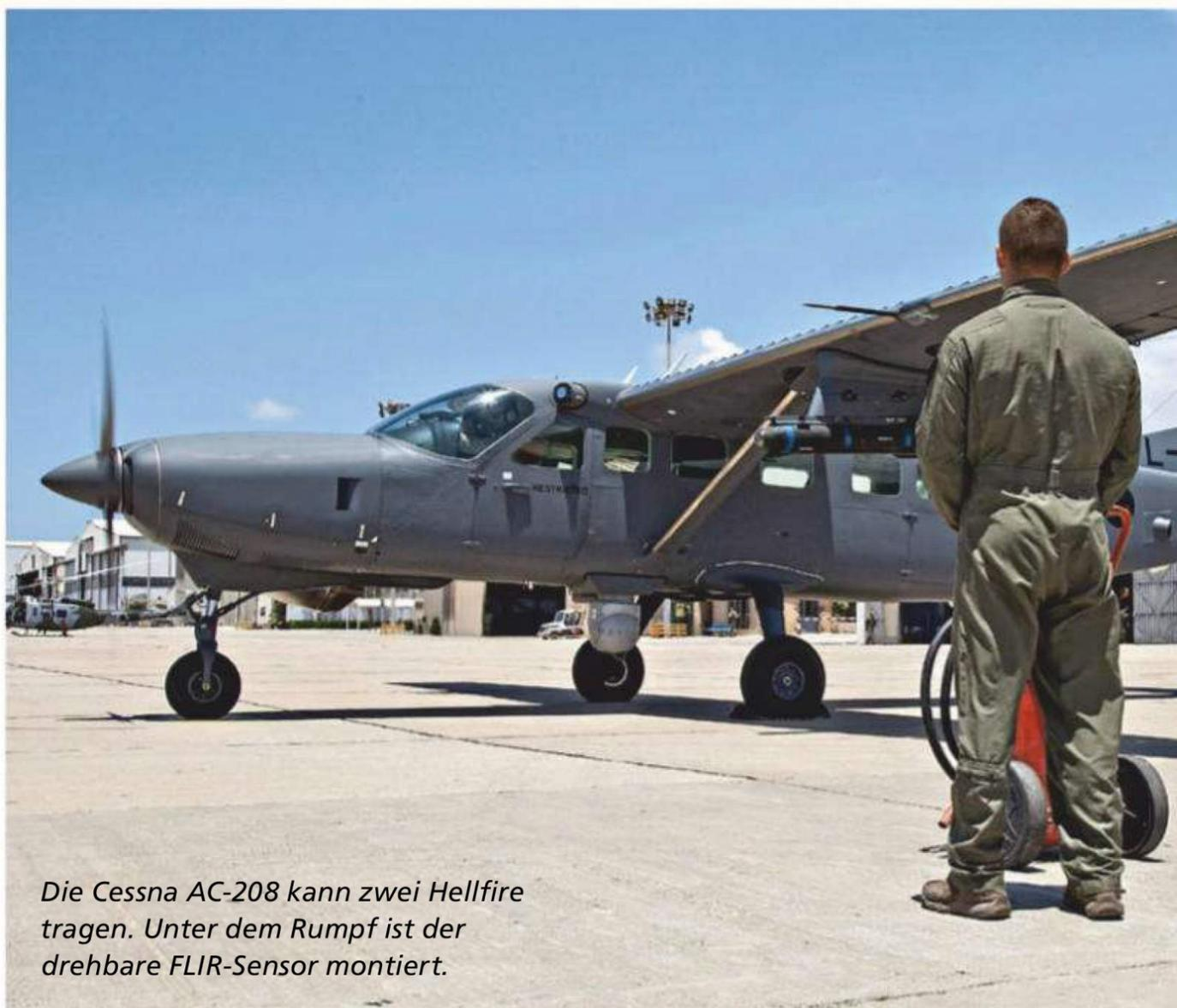
*Die Cessna AC-208 kann zwei Hellfire tragen. Unter dem Rumpf ist der drehbare FLIR-Sensor montiert.*
