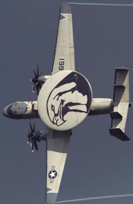
El radomo del "Hawkeye" es capaz de emplear múltiples métodos de barrido (foto Hans Antonissen).
