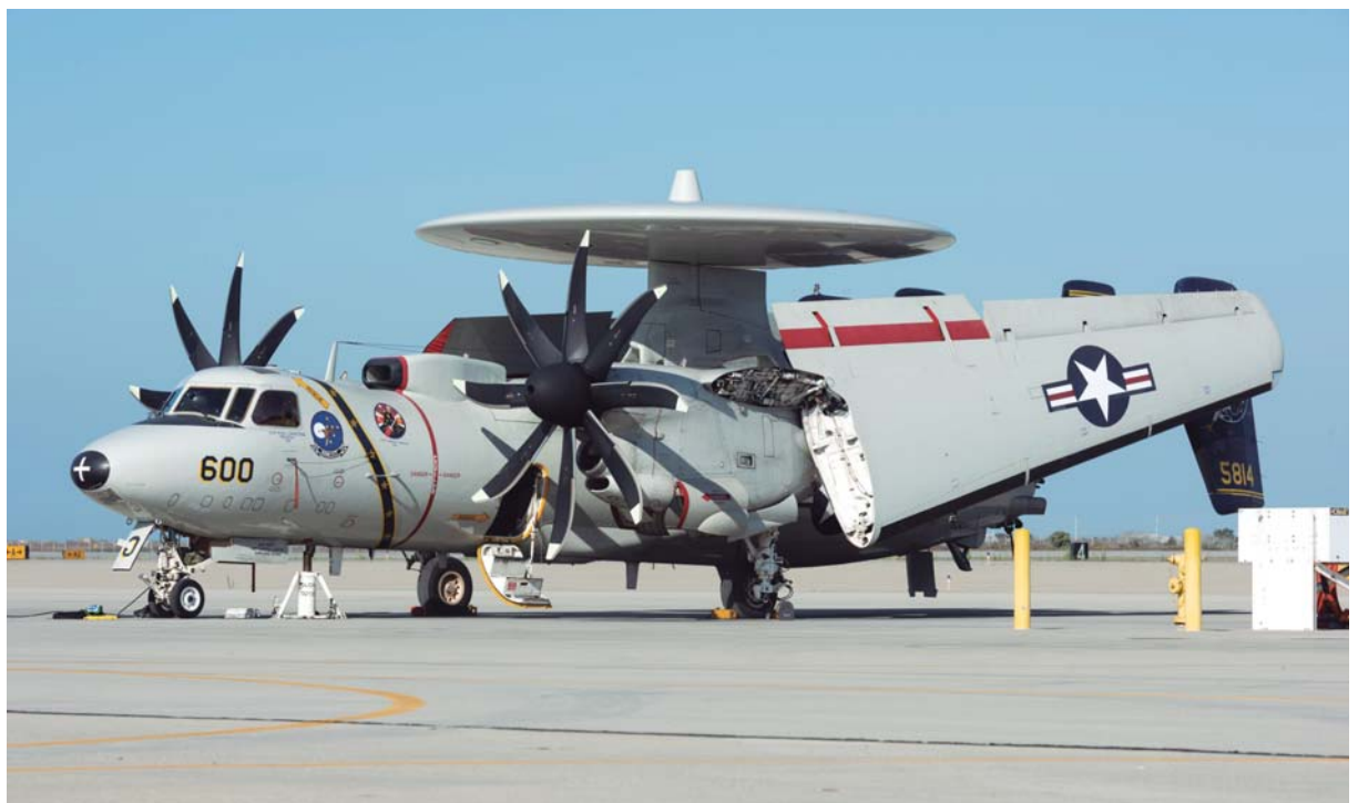
El VAW-117 está basado en la NAS Point Mugu, en la costa Oeste. Cuando las aeronaves están estacionadas en la línea de vuelo, las alas se pliegan para contar con más espacio, característica muy útil en la cubierta de un portaaviones (foto Patrick Roegies).
